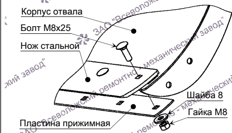
Рис.5 Крепление ножа
